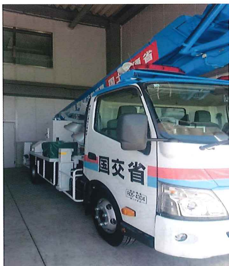
1 km先まで届く投光器を積載した 国土交通省の大型トラック
